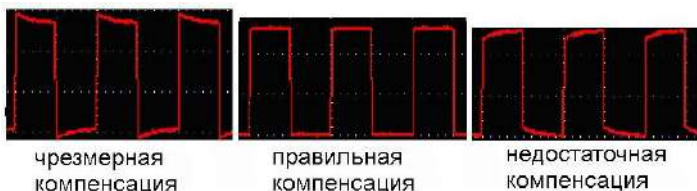
Рисунок 7 - Варианты осциллограммы при компенсации щупа
