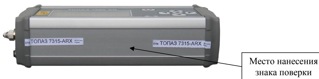
Рисунок 2 - Схема пломбировки тестеров от несанкционированного доступа, обозначение места нанесения знака поверки
