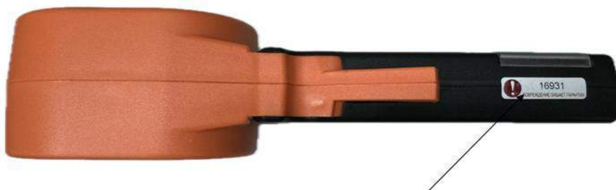
Место пломбирования от несанкционированного доступа
