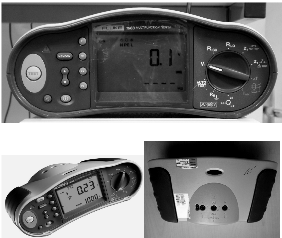
Рисунок 1 - Внешний вид тестеров электрических установок Fluke 1662, Fluke 1663, Fluke 1664 FC в разных ракурсах и при разных масштабах Стрелкой показано место нанесения на верхнюю поверхность корпуса знака утверждения типа и поверочного клейма
