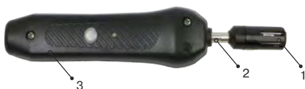
Рис.А.9 См рт-зонд для измерения атмосферного (СЗДА, СЗДАП)
