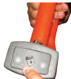
в) Уст новить б т рейный отсек в корпус, н д вить н отсек до ср б т ы в ния фикс тор
