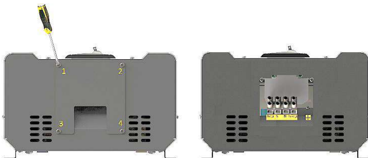
Рисунок 12. Схема снятия защитной крышки снизу корпуса стабилизатора
