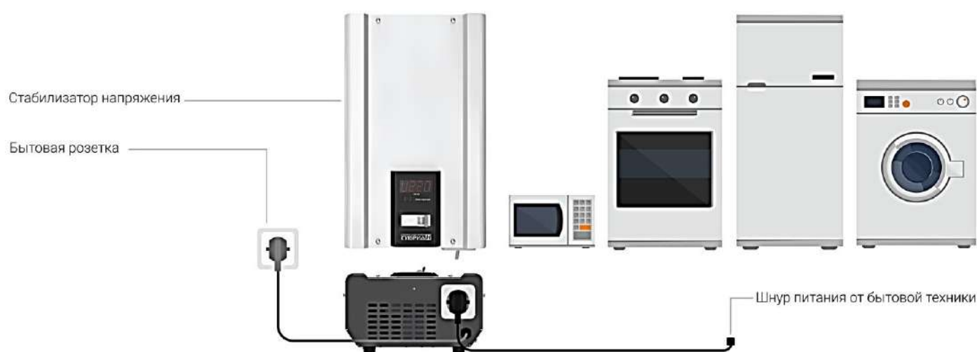
Рисунок 13. Подключение стабилизатора к сети
