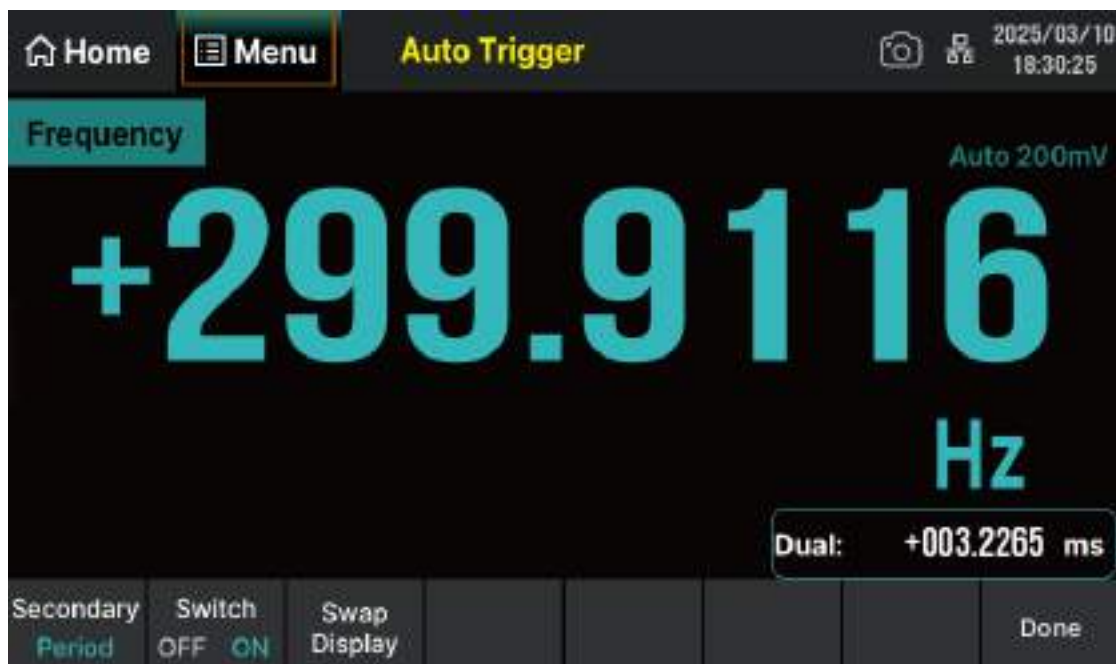
Рис. Интерфейс с двумя дисплеями (основной дисплей - частота Frequency, вспомогательный - период Period)
