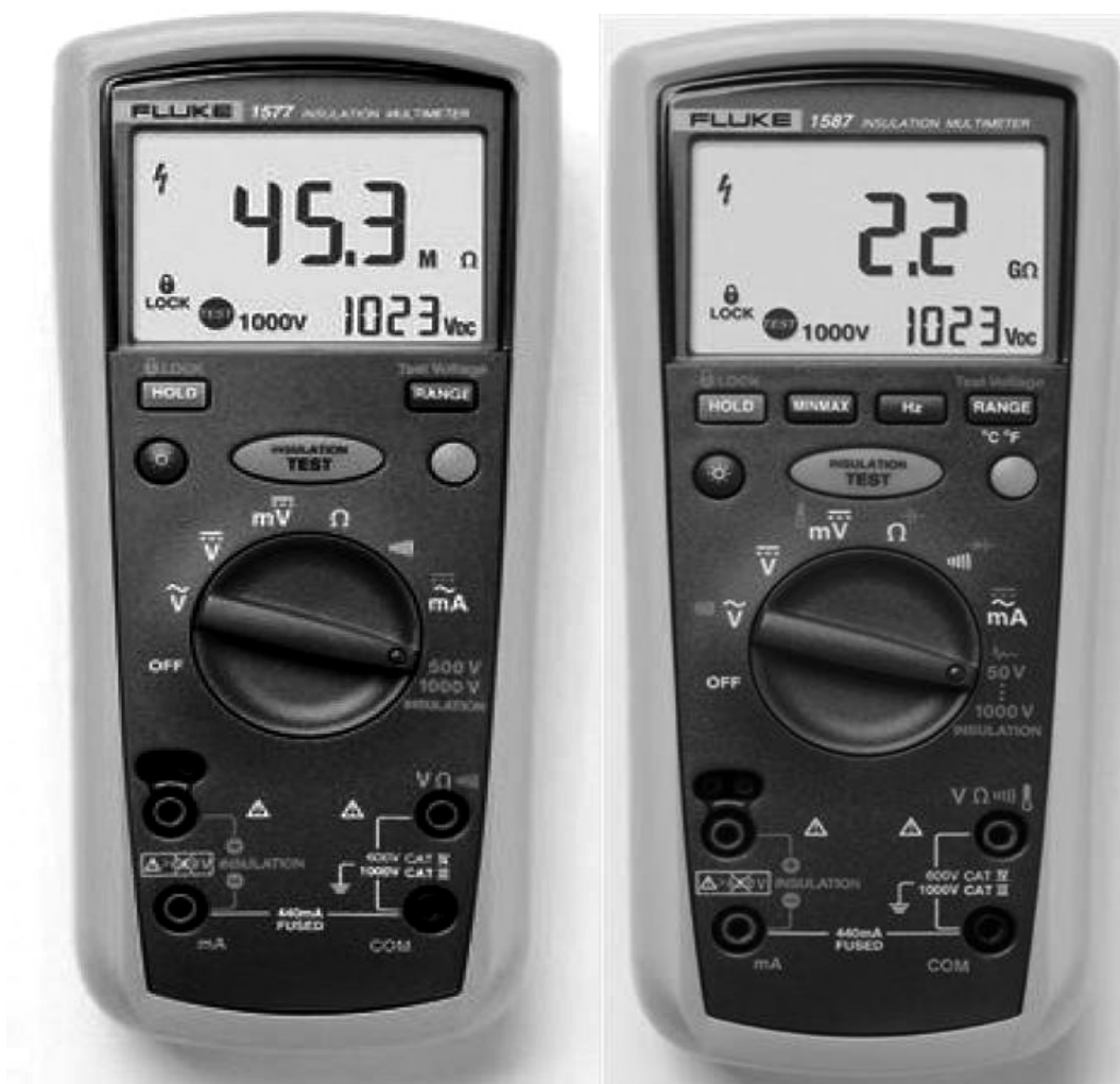
Рисунок 1 - Внешний вид мультиметров – мегаомметров Fluke 1577 (слева) и Fluke 1587 (справа).
