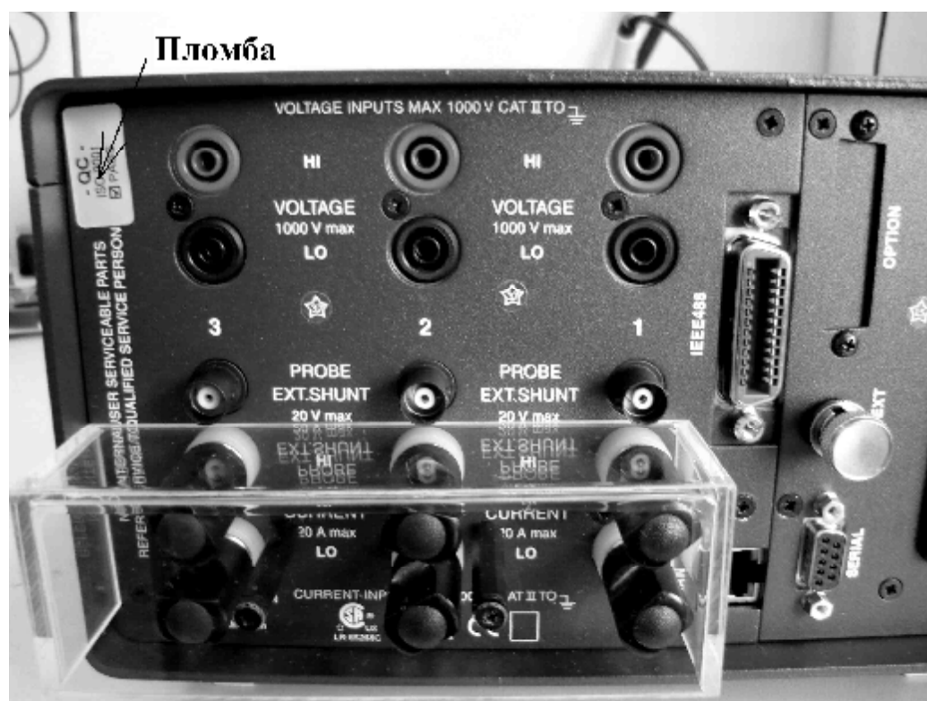
Рисунок 3. Схема пломбирования регистраторов модели Fluke Norma 4000.
