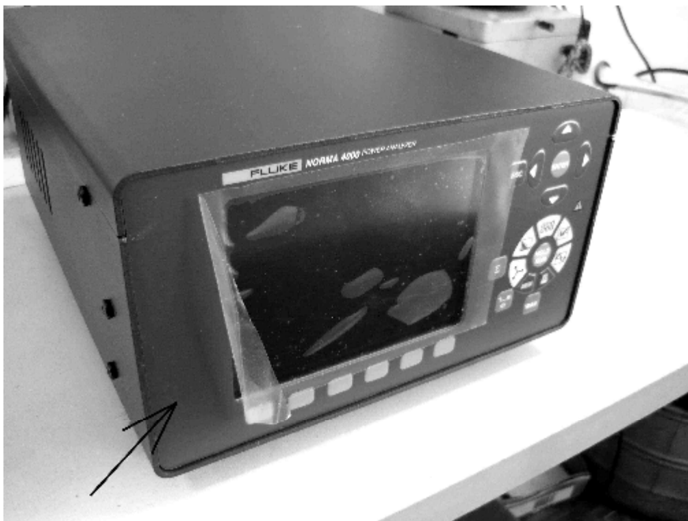
Рисунок 1. Внешний вид регистратора модели Fluke Norma 4000, стрелкой показано место нанесения знака утверждения типа.
