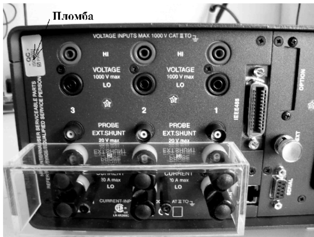
Рисунок 3. Схема пломбирования регистраторов модели Fluke Norma 4000.
