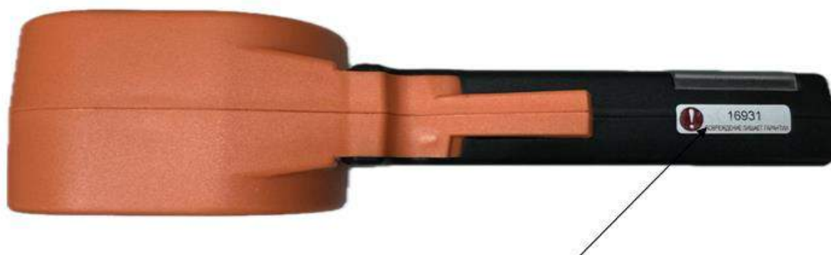
Место пломбирования от несанкционированного доступа
