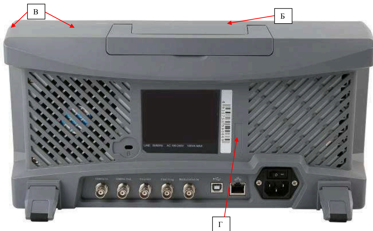
Рисунок 2 – Виды задней и верхней панелей генератора с местами нанесения знака поверки (Б), пломбировки от несанкционированного доступа (В) и серийного номера (Г)
