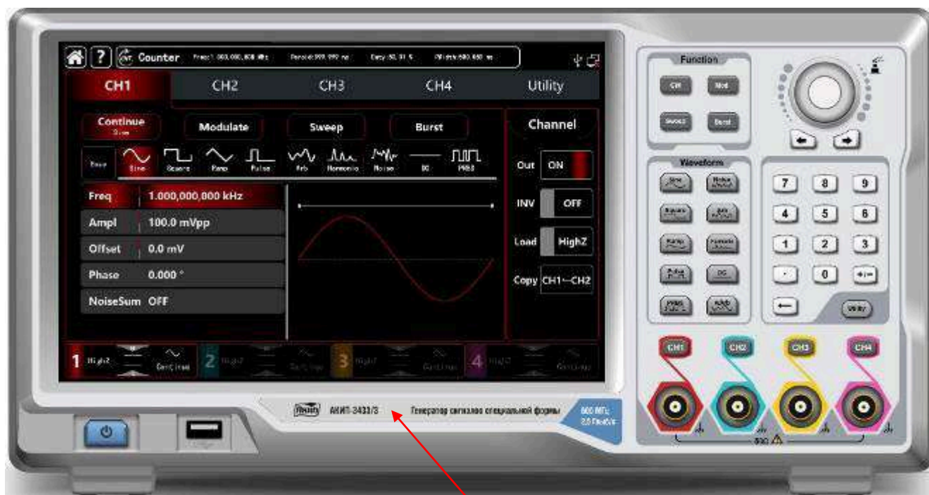
Рисунок 1 – Внешний вид передней панели генератора с местом нанесения знака утверждения типа (А)
