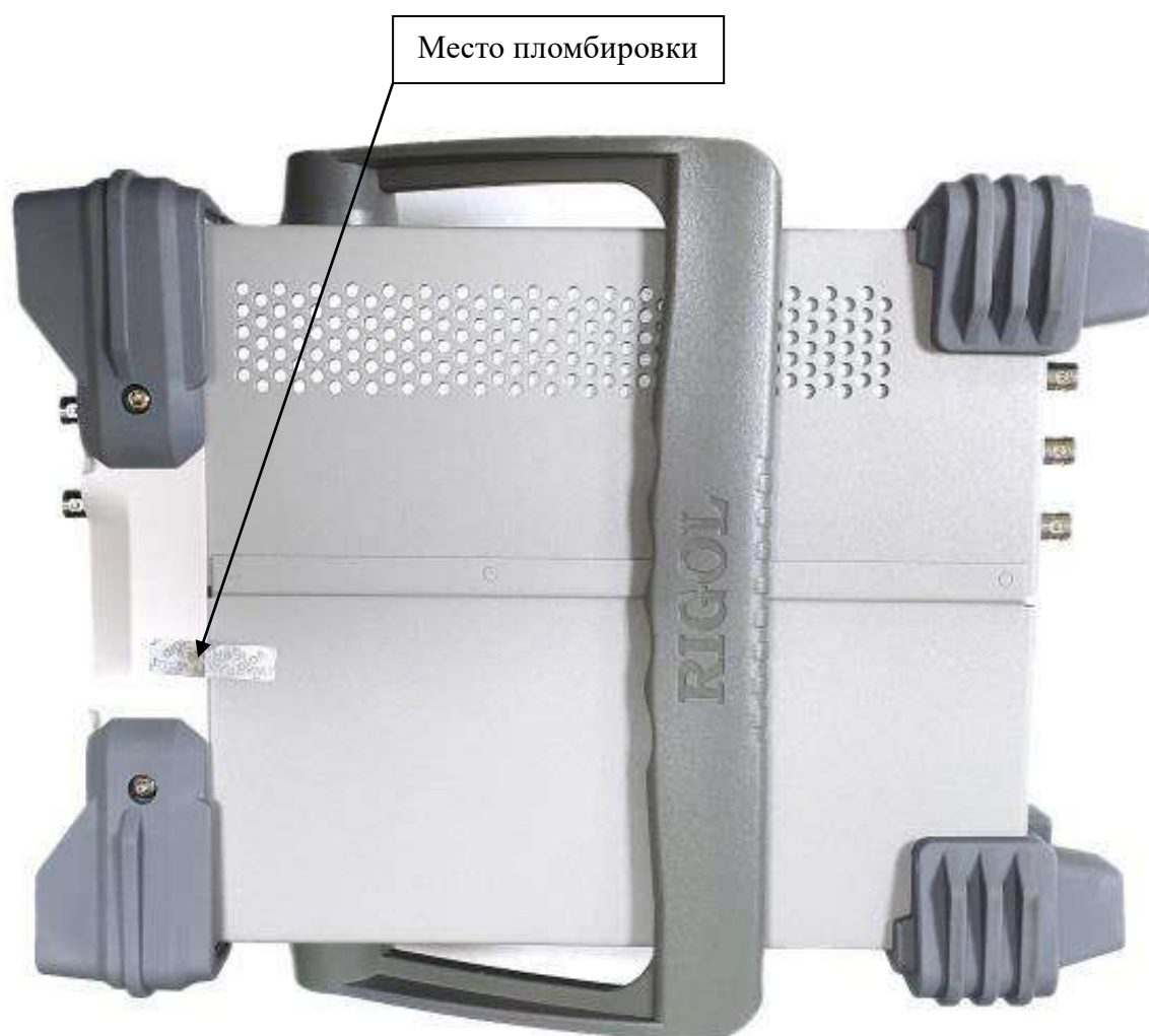
Рисунок 3 – Схема пломбировки от несанкционированного доступа
