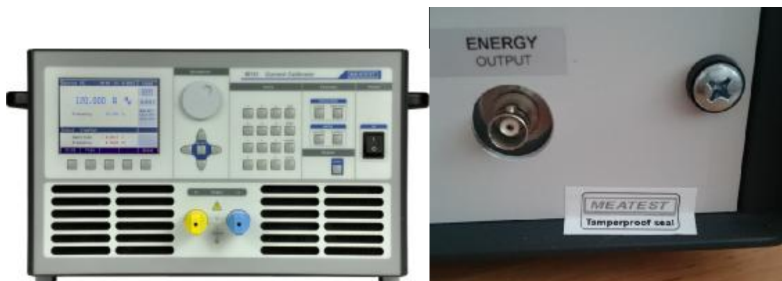
Рисунок 1 – Фотографии передней панели и пломбировки калибраторов
