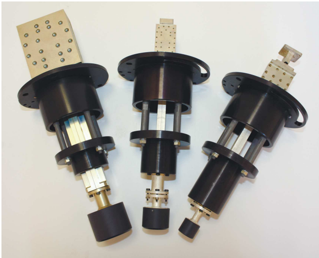
На фото: Облучающие системы для различных участков диапазона.
