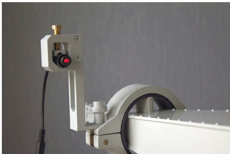
На фото: Пример установки кронштейна КЛ-1 на узел крепления антенны. (в сборе с лазерным маркером и измерительной антенной)
