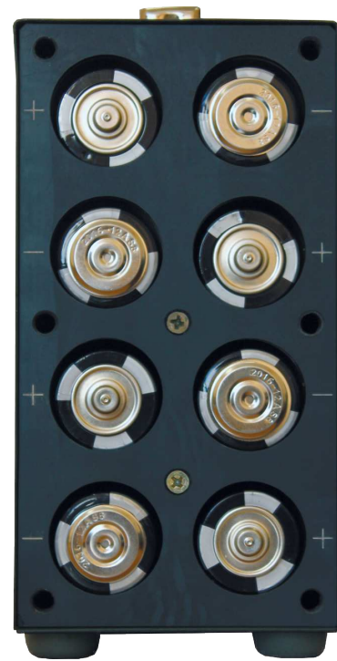
На фото: Батарейный отсек БНП-1 со снятой крышкой.
