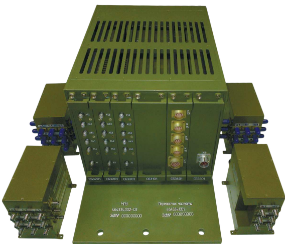
На фото: 3-канальный преобразователь частоты диапазона 0,1 - 18,0 ГГц, серии Радиотехника-1
