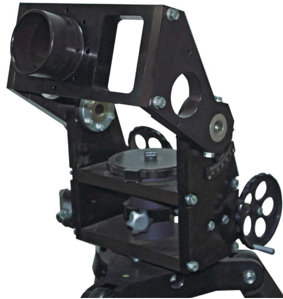
На фото: Опорно-поворотное устройство (ручное).
