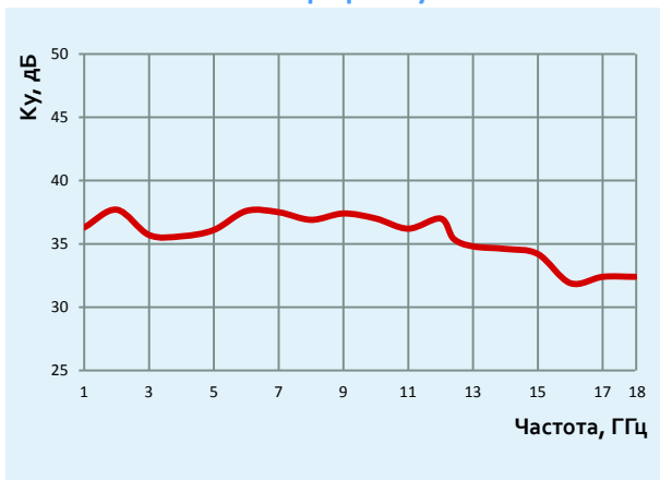
Типовой график K_u с МШУ
