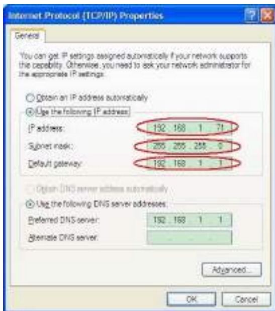
Рисунок 7-5 Настройка сетевых параметров компьютера
