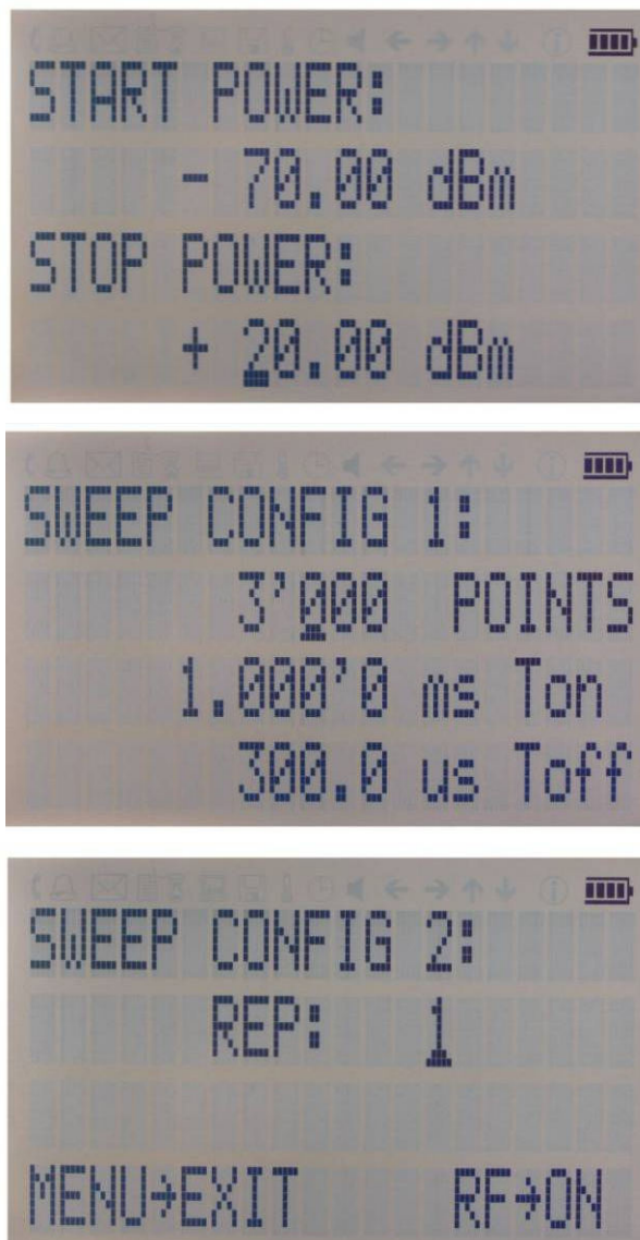
Рисунок 4-с. Экраны настройки sweepирования мощности
