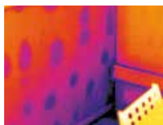
ИК-изображение показывает плесень на внутренней стене, которая появилась из-за просачивания воды
