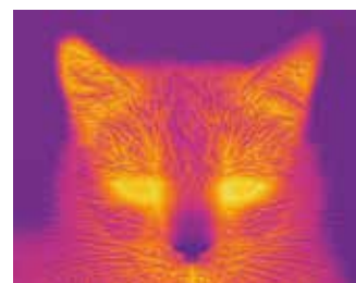
Тепловизионное изображение, улучшенное с помощью функции «Настройка контрастности»
