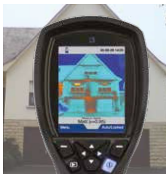
FLIR i3 измеряет температуру в 3 600 точках
