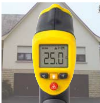
ИК-термометр измеряет температуру в одной точке
