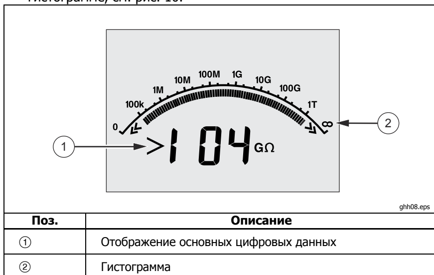
Рисунок 11. Отображение измеренного сопротивления изоляции
