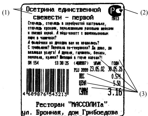
Рис. 7. Пример печати этикетки формата 9. Этикетка размером 58 x 60 мм, без препринта.
