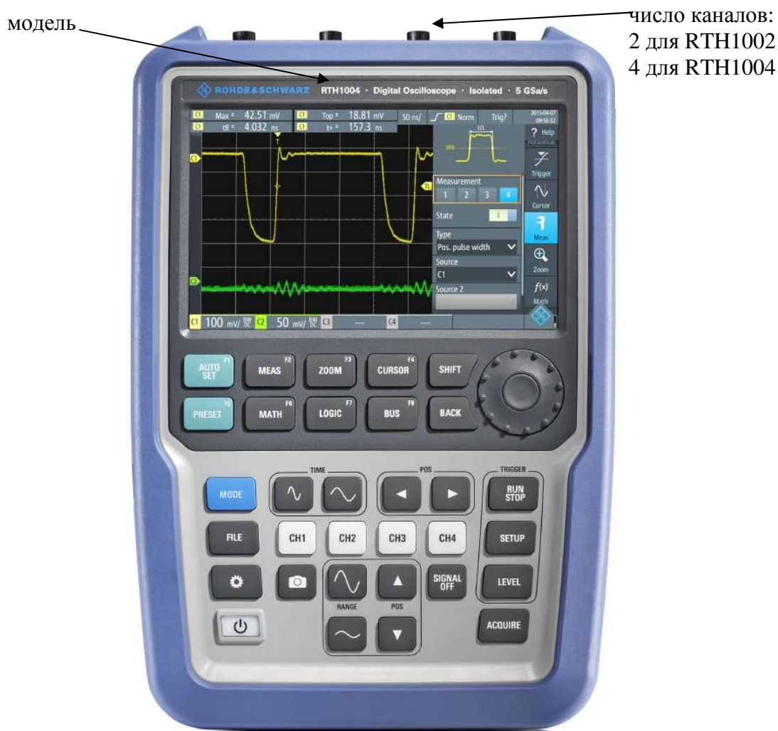
Рисунок 1 - Внешний вид осциллографов цифровых портативных RTH1002, RTH1004
