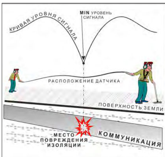
применение датчик-определителя дефектов коммуникации (ДОДК) методом min
