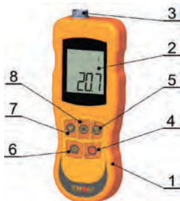
Рис.6 Основные части прибор ТК-5.06С, органы управления
