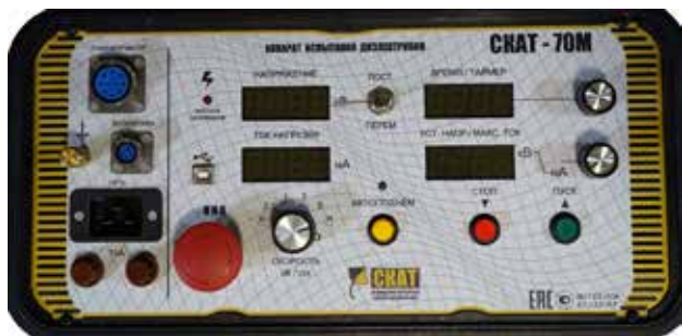
Рис. 2. Внешний вид передней панели блока управления.
