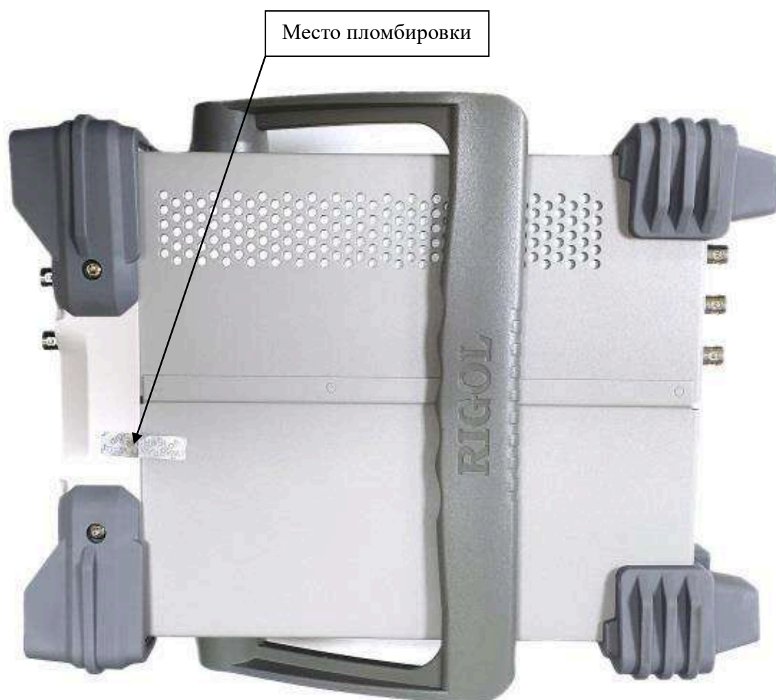
Рисунок 3 – Схема пломбировки от несанкционированного доступа
